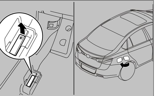
3. 逆时针缓慢旋转油箱加油口盖，打开油箱加油口。
