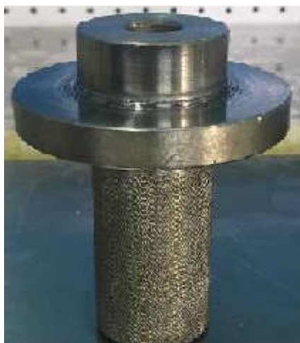
(5) 主壳体半轴油封 (8AT032101004) 安装工装
