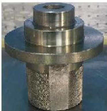
(5) 主壳体半轴油封 (8AT032101004) 安装工装
