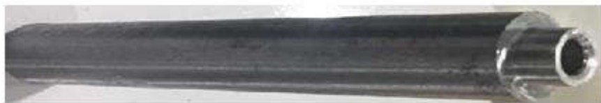
(4) 变矩器壳体半轴油封 (8AT032101004) 安装工装
