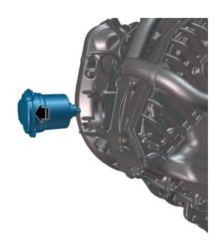
9.移除下部电机,并作标记以 确保电机装回时与原位置一致, 同时保证无污染物进入变速箱。
