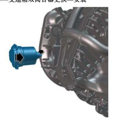
**23**.安装下部电机,请使用较小的力。 ❖注意不要损坏电机轴头部的花键。
