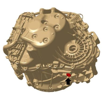
4.将放油螺塞装回, 拧紧力矩39-47 Nm。
