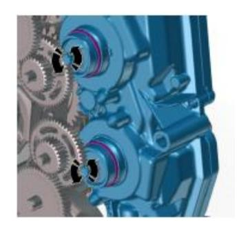
7.小心转动控制模块上的齿轮以使齿轮相互啮合。
