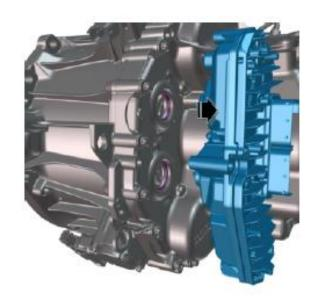
4.拆除控制模块。确保变速箱中无污染进入。
