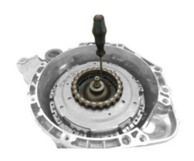
20.将驱动小齿轮安装在内输入轴(实心轴), 并确保V型凹槽处于正确位置。
