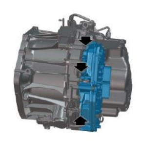
1.清洗控制模块周围的区域。 使用合适的洗涤液和压缩空气。
