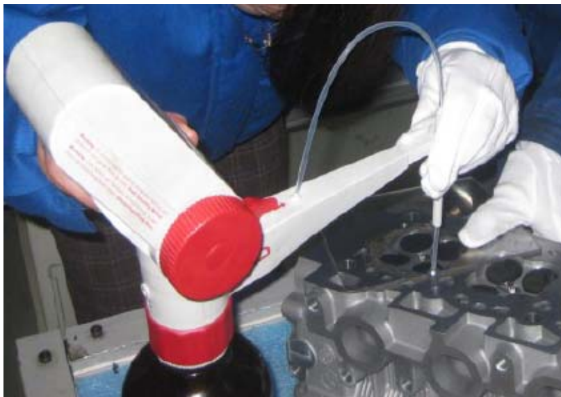
图 B-7 气缸盖燃烧室容积检测示意图
