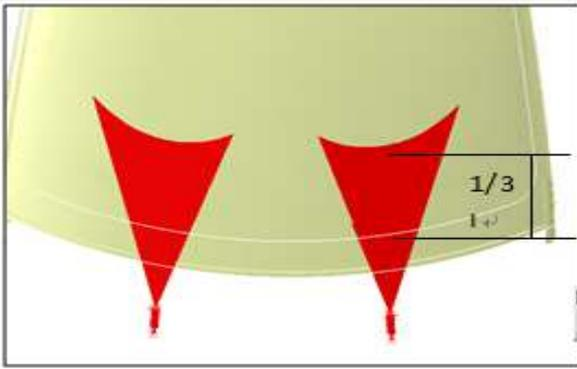
2. 如果喷嘴喷洒范围不正常，可用钢丝拨动喷嘴内喷口方向直至喷嘴方向正确。
