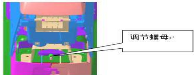
4. 如上图所示，即可看到调节螺母，用扳手旋紧或旋松手制动调节螺母。要求：手制动放下时，转动后轮轻松自如，手制动拉起 1 齿消除空行程，同时允许产生驻车力，拉起 2~3 齿后轮抱死。
