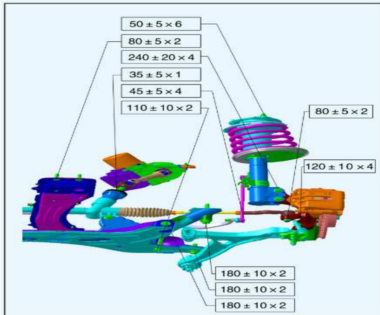
该图为底盘日常保用力矩复紧参照位置及力矩图示，方框内的数据为该点力矩数值×螺栓（母）单车用量，如 120 ± 12 × 2 表示：该点力矩为 120 ± 12 牛米，该点螺栓（母）单车用量 2 个。图示为前后悬挂的半边，另一对称位置参考图示位置及力矩复紧
