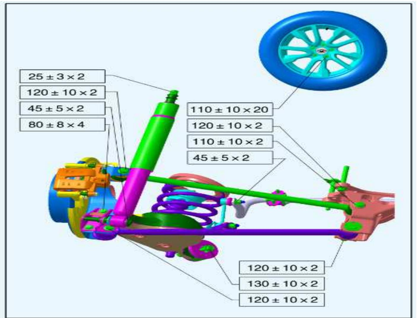
该图为底盘日常保养用力矩复紧参照位置及力矩图示，方框内的数据为该点力矩数值×螺栓（母）单车用量，如  $120 \pm 12 \times 2$  表示：该点力矩为  $120 \pm 12$  牛米，该点螺栓（母）单车用量 2 个。图示为前后悬挂的半边，另一对称位置参考图示位置及力矩复紧
