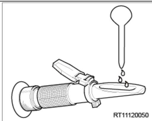
2. 如图所示，用冰点测试仪的右侧测量乙二醇冷却液，左侧测量聚丙烯乙二醇冷却液和中间测量蓄电池的电解
