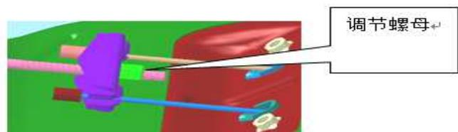
5. 将手制动手柄反复拉起4-5次，并拉起手制动手柄4齿后，用M6自锁螺母紧固（力矩：4.0±0.5N.m）
