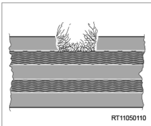
(2) 座椅安全带边缘破裂。
