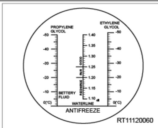
3. 测量车辆上使用的乙二醇冷却液时，应观察仪表的右侧。
