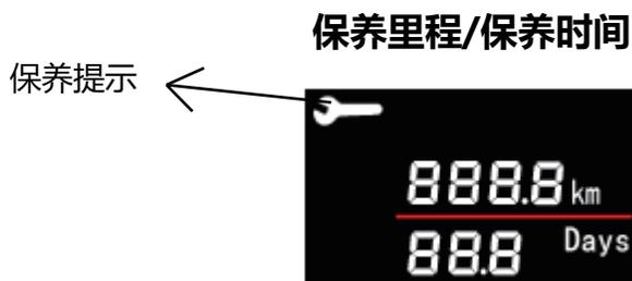
到达定期检查后，点火开关转至“ON”，LCD显示屏显示维修提醒的警告信息。维修提醒时伴有蜂鸣器提醒。
