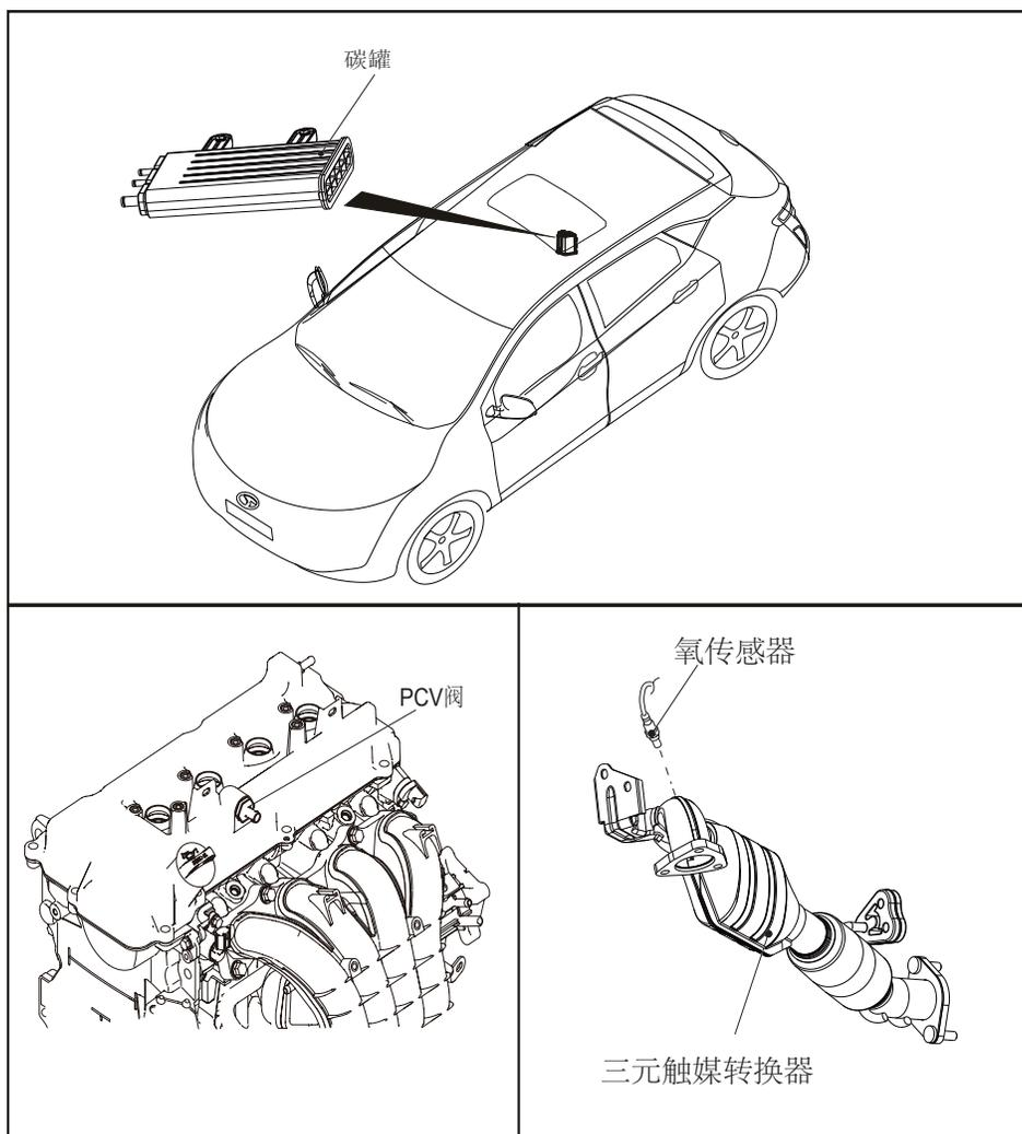
本车排放控制系统已通过现行法规审核。废气排放系统主要包括以下几个部分（废气排放系统因发动机型号不同会有差异，具体配备以实车为准）：
