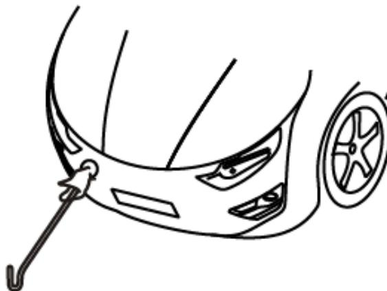
3. 使用车轮螺母扳手牢固固定牵引钩。
