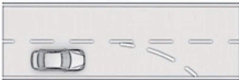
当车辆行驶前方道路存在较明显的道路干扰线时，LKA系统可能由于道路干扰线导致识别道线质量下降而功能退出，也可能由于道路干扰线干扰而发生异常转向的现象。
