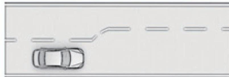
当车辆行驶至前方路面强烈颠簸或坑洼不平道路时，LKA系统可能由于路面激励导致方向盘异常波动，或由于车辆强烈颠簸导致道线识别异常而发生功能退出。
