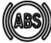
如果系统发生故障，ABS警告灯将点亮，仪表显示器的信息画面上将出现警告信息。
