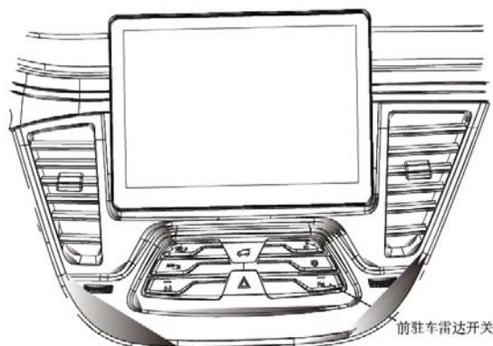
电源模式打开（ON），压下前驻车雷达开关（ON），听到哔声时表示系统开始作用，系统依照车速状况启动侦测功能。再压一下前驻车雷达开关（OFF），系统不作用。
